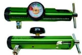
CUERPO TOTALMENTE CROMADO QUE TRABAJA A GRAN PRESIÓN, CONEXIÓN CGA-540, MÁXIMA PRESIÓN DE ENTRADA DE 3000 PSI, DIAFRAGMA DURABLE DE NEOPRENE, FILTRO SINTERIZADO PARA EXTENDER LA VIDA DEL REGULADOR, MANÓMETROS: 2" DIÁMETRO (0-200 PSI) (0-4000 PSI), CAUDAL DE 0 A 15 LITROS POR MINUTO.
